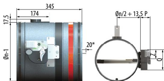
\* Dépassement de la lame de 20 mm uniquement pour Ø 315.
